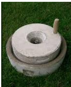
Handdrehmühle, bei welcher der obere Stein von Hand gedreht wird.
