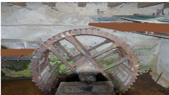
Über die Rinne rechts oben schlug Wasser ober-schlächtig auf das Wasserrad mit einem Durchmesser von 2,60 m, während Wasser aus einer zweiten Rinne von links seitenschlächtig aufschlug. (Die Rinnen sind zur Verdeutlichung nachgezeichnet).
