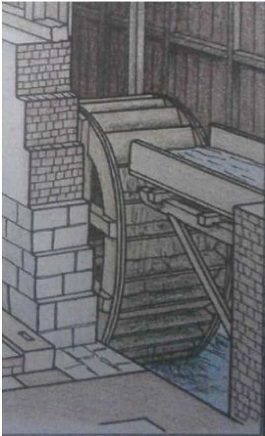
Konstruktions-skizze des geänderten Wasserantriebes (R. Hagen).
