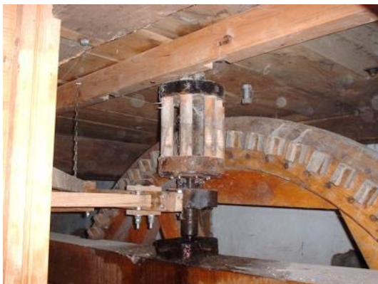
Das große Kammrad treibt das kleine Stockrad an.
