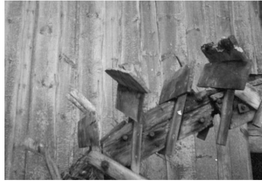
Hier die abgewinkelten Schaufeln des Wasserrades.
