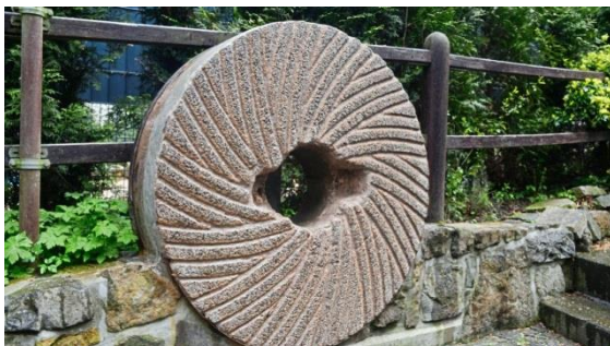
Bei diesem in einen Zaun integrierten Mahlstein sind die Luftfurchen gut erkennbar.
