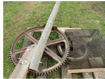
(Kegelrad-)Getriebe eines Göpels.
