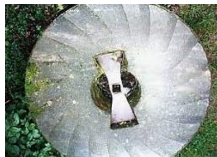
Mühlstein mit Mühleisen / Haue von unten.
