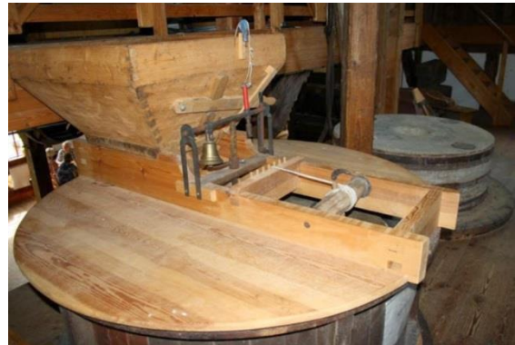
„Alter deutscher Mahlgang“ in der Cordinger Wassermühle (bei Bomlitz) mit Trichter, Rüttelschuh, Leerlaufglocke, Mühlsteinen und Bütte.
