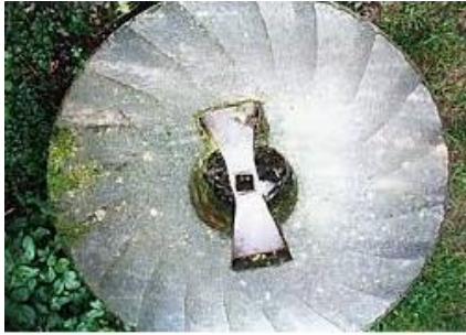
Mühlstein mit Mühleisen / Haue von unten.
