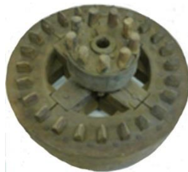
Diese beiden aufeinandergesteckten Kammräder aus dem Getriebe der Bissendorfer Bockwindmühle werden in der Dauerausstellung des Bissendorfer Heimatmuseums gezeigt.
