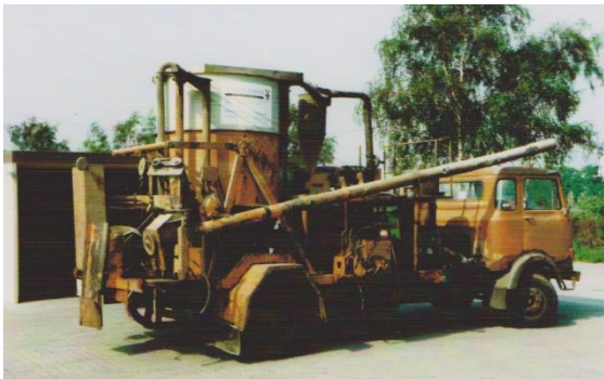
Die auf einem LKW aufgebaute mobile Mahl- und Mischanlage.
