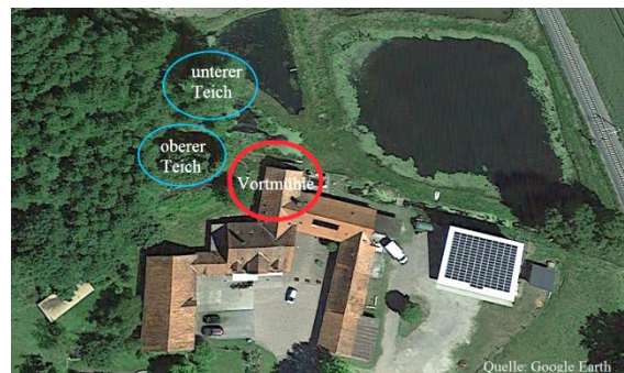
Mit ihren beiden Zuläufen aus zwei Teichen mit unterschiedlichem Höhenniveau war die Vortmühle eine wassertechnische Besonderheit.
